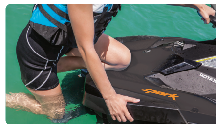
Escalón para embarque (Opcional) Hace que el embarque desde el agua sea más fácil y rápido.
